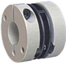
Transmission de rotation sans jeu, rigidité en torsion élevée, forces de redressement moyennes, amortissement des vibrations, isolant électrique. Adapté pour les dispositifs de mesure, pour les vitesses de rotation élevées.
