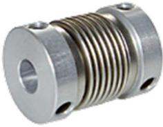
Transmission de rotation sans jeu, compensation de tous types de mésalignements, rigidité en torsion élevée, forces de redressements faibles, amortissements des vibrations.
