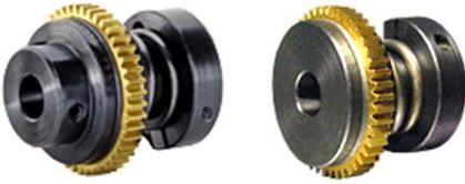
Ces limiteurs de couple sont étudiés pour protéger un train d'engrenages des surcharges pouvant entraîner sa rupture. Le couple de débrayage est aisément réglable par écrou ou par collier de serrage.
