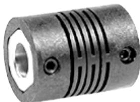
Transmission de rotation, très économique, rigidité en torsion moyenne, force de redressement faible, isolation électrique, amortissement des vibrations. Inserts métalliques dans les alésages pour un serrage optimum des arbres. Le dégagement intérieur réalisé au niveau des hélicoïdes permet aux arbres de pénétrer dans le corps de l'accouplement.
