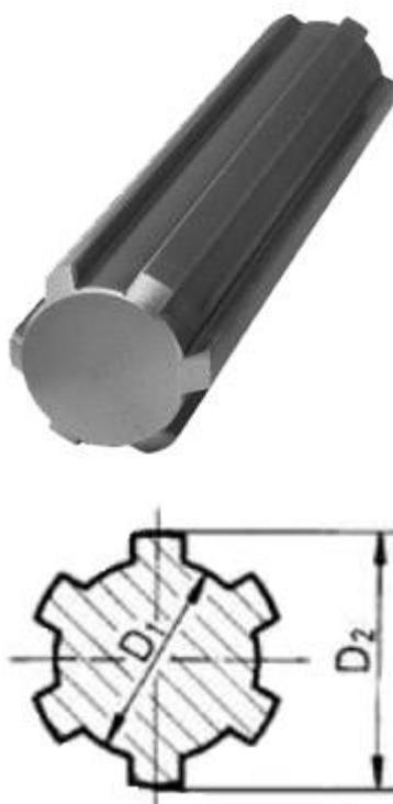
Les arbres cannelés sont fabriqués en acier inoxydable. Ils sont utilisés pour la transmission de couples élevés tout en assurant la translation axiale.
