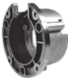
La cloche de montage MOGL 5038 propose un assemblage rapide et économique de tous les codeurs avec une bride synchro. Fabriquée en PPS renforcé de fibres de verre, elle assure une isolation thermique et électrique. La liaison entre cloche et codeur peut se réaliser par 3 vis DIN912 M4 x 10 ou par 3 brides excentriques.
