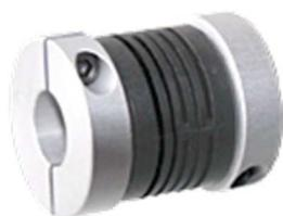
Transmission de rotation, très économique, rigidité en torsion moyenne, force de redressement faible, isolation électrique, amortissement des vibrations. Inserts métalliques dans les alésages pour un serrage optimum des arbres. Le dégagement intérieur réalisé au niveau des hélicoïdes permet aux arbres de pénétrer dans le corps de l'accouplement. Avec moyeux à serrage concentrique pour un montage sans marquage des arbres.
