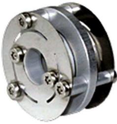
Transmission de rotation sans jeu, rigidité en torsion élevée, forces de redressement faibles, amortissement des vibrations, membranes extrêmement robustes en acier inoxydable.
