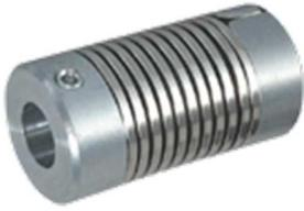
Transmission de rotation, rigidité en torsion faible, force de redressement faible, forte capacité d'amortissement des vibrations, aucun élément en mouvement, exécution robuste, très économiques.
