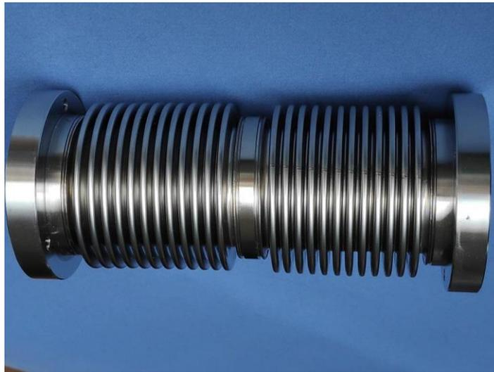
Le soufflet moleté ou compensateur de dilatation métallique circulaire à ondes en « U » permet de reprendre des déplacements axiaux, latéraux et angulaires, il est conçu sur demande et sur mesure.
